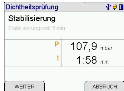
Während und am Ende der Messung werden der Druck zu Beginn der Messung (P-Start), der aktuellen Druck bzw. den Druck am Ende der Messung (P), die Druckdifferenz und die bisher verstrichene Messzeit (t) angezeigt.
