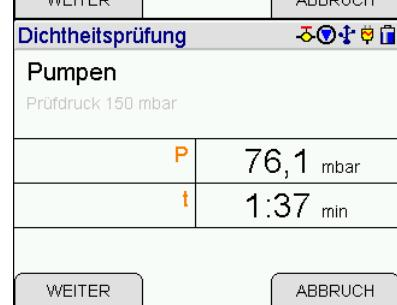
Hat der Druck den Prüfdruck erreicht, wird die interne Pumpe automatisch gestoppt.
