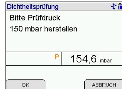
Der weitere Ablauf einer Dichtheitsprüfung wird in Kap. 13.1 beschrieben.
