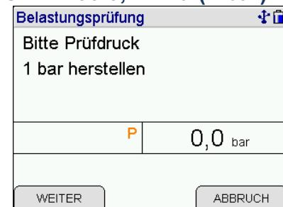
Die externe Pumpe über ein Ventil mit der Leitung verbinden und den Druck erhöhen.
