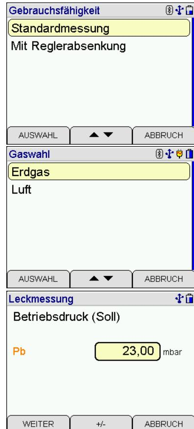
Bei Betriebsdrücken > 30 hPa (mbar) ist der tatsächliche Betriebsdruck als Sollbetriebsdruck anzusetzen, sonst ist der Betriebsdruck auf 23,00 hPa (mbar) einzustellen.
