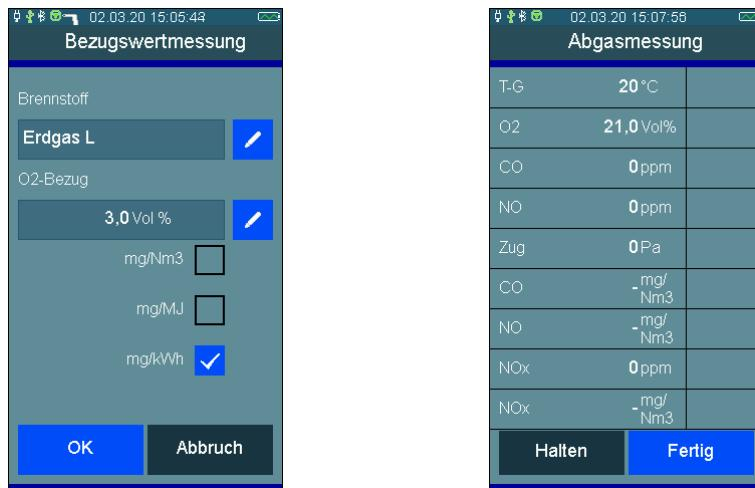
Bei der Anzeige in mg/Nm<sup>3</sup>, mg/MJ und mg/kWh werden vor der Messung der Brennstoff und der O<sub>2</sub>-Bezugswert ausgewählt. Bei der Anwahl eines Brennstoffs ist der standardmäßige O<sub>2</sub>-Bezugswert voreingestellt.
