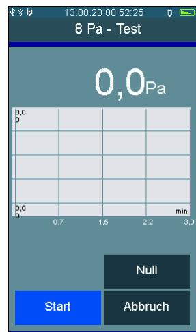
Das FG7500 meldet akustisch den Ablauf von 30 Sekunden. Mit **Stop** kann die Druckverlaufsaufzeichnung unterbrochen werden.
