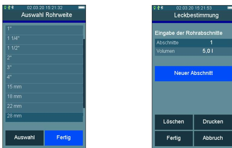
Eine Tabelle mit den einzelnen Rohrabschnitten kann ausgedruckt werden.
