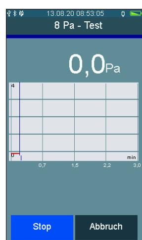
Alle vorhandenen Luftabsaugenden Einrichtungen sind in Betrieb zu nehmen. Dabei muss die Messung den ungünstigsten Zustand erfassen, d.h. die Beurteilung ist mit der höchsten Leistungsstufe der Luft absaugenden Einrichtungen durchzuführen. In den Fällen, in denen sich die Entlüftungseinrichtung nicht im gleichen Raum wie die Feuerstätte befindet, sind alle Türen und Öffnungen zwischen dem Aufstellraum der Feuerstätte und der Entlüftungseinrichtung offen zu halten.
