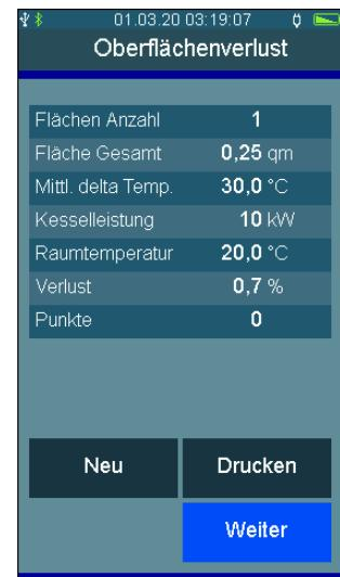
Mit „**Weiter**“ wird das Ergebnis übernommen und man gelangt zur Übersicht der Messprogramme des „Heizungs-Checks“, wobei nun der Oberflächenverlust und die erreichten Punkte angezeigt werden.
