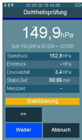
Messung: In der Messzeit werden der Druckverlauf, sowie Start-, End- und Differenzdruck aufgezeichnet. Die ausgewählte Messzeit kann durch „Beenden“ verkürzt werden.
