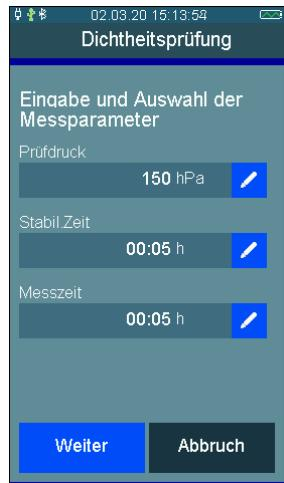
„Weiter“ startet das Messprogramm. Während der Messung kann mit „>/<“ jederzeit zwischen Tabellen- und Diagrammdarstellung umge-schaltet werden.
