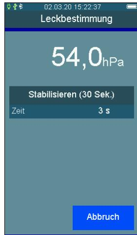
Der aktuelle Druck, der Druck zu Beginn der Messung, die bisher verstrichene Messzeit, der Druckabfall und die derzeit ermittelte Leckrate werden angezeigt.
