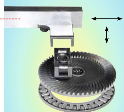
Стабильный, прямоугольный ходовой маятник Из прочной, специальной стали, по направлению нагрузки точно посажен на игольчатые подшипники, которые направляют маятник с обеих сторон по всей длине хода, для ровного прямоугольного без скосов реза даже при жесткой эксплуатации с многократно усиленным давлением на пильное полотно, например, при использовании бугеля. Для сверхдолгого срока службы.
