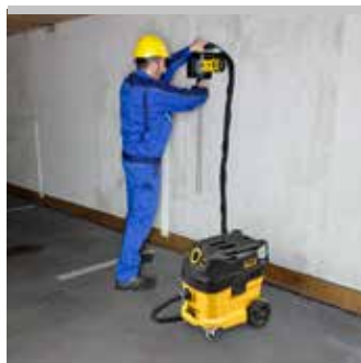
Aspiratori e depolveratori certificati per raccogliere polveri nocive secondo EN 60335-2-69.
