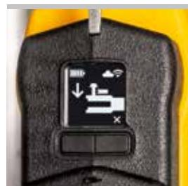
Posizione di chiusura del perno di fissaggio della pinza monitorata elettricamente.
