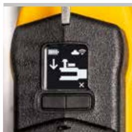
Contrôle électrique du verrouillage de l'axe de maintien de la pince à sertir.
