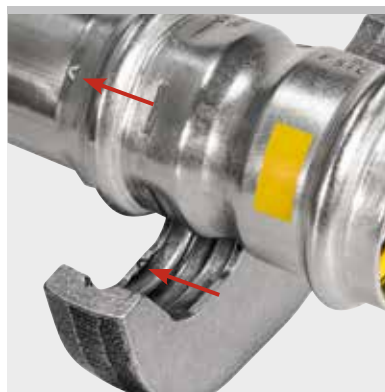
Beispiel REMS Presszange Mini V: Abdruck „V“ auf gepresstem Fitting zur Rückverfolgbarkeit gemäß EN 1775:2007
