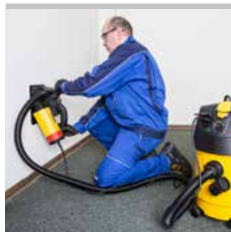
Vollflächig anliegende Auflageplatte während des gesamten Schlitz-/Trennvorgangs für geführtes Eintauchen der Diamant-Trennscheiben, staubfreies, sicheres Arbeiten und leichten, gleichmäßigen Vorschub
