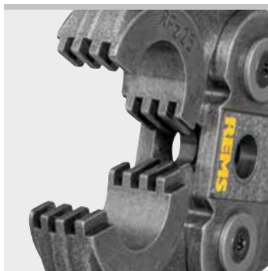
Presszangen mit Verzahnung verhindern Gratbildung am Pressfitting Patent EP 2 027 971
