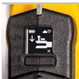
Schließstellung des Zangenhaltebolzens elektrisch überwacht.
