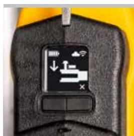
Schließstellung des Zangenhaltebolzens elektrisch überwacht.
